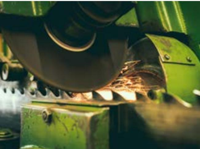
Wenn die Funken sprühen, wird das Sägeblatt wieder scharf.
